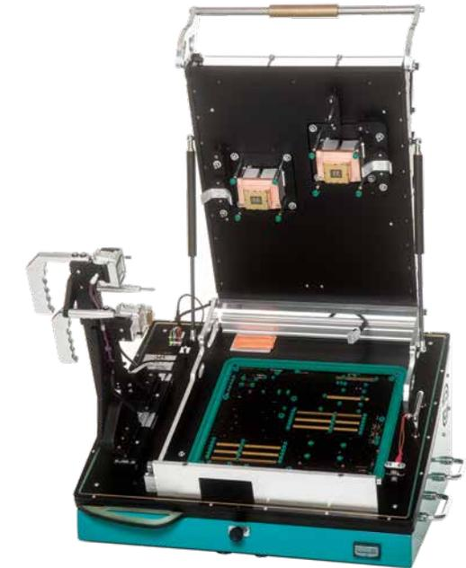
Vakuumadapter sind für sämtliche gängigen Testsysteme geeignet und überzeugen in jeder Hinsicht durch Leichtigkeit, Schnelligkeit und Wirtschaftlichkeit. Wir passen die Vakuum-Kassette exakt an die Größe der entsprechenden Leiterplatte an und gewährleisten so eine schnelle Ansaugung bei minimalem Gerätegewicht. Die Adapter werden vor der Auslieferung einer lückenlosen Qualitätsprüfung inkl. Verdrahtungstest unterzogen.
