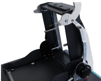
Der zukünftig erhältliche erweiterte Öffnungswinkel von bis zu 90° ermöglicht einen komfortablen Zugang für Mitarbeitende und Roboter gleichermaßen – ideal für das einfache Beladen und Entnehmen der Baugruppe. Damit ist eine nahtlose Integration in automatisierte Abläufe gewährleistet und der Einsatz in automatisierten/roboterbasierten Prozessen optimal unterstützt.
