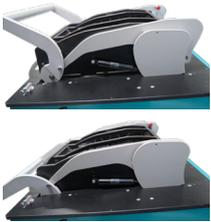
Standardmäßig sind unsere Adapter (unabhängig von der Serie) mit einem Linearhub ausgestattet. Beim MMI beträgt dieser 22 mm. In Verbindung mit der Vorzentrierung der schwimmend gelagerten Niederhalteplatte (auch beim Wechselsystem) über Bolzen und teflonisierten DUT-Buchsen werden Bauteiltreffer auch an eng bestückten Baugruppen vermieden. Dadurch wird eine ausnahmslose Reproduzierbarkeit des Trefferbildes (bei TOP-Kontaktierung) und des Kontaktierhubes lebenslang sichergestellt.
