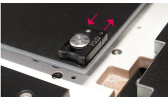
Die Boardträgerplatte ist über **vier einfach zu öffnende Verriegelungen werkzeuglos** abzunehmen. Dadurch ist der Zugang zu den gefederten Kontaktstiften und Kontaktsteckhülsen problemlos möglich – ideal für Wartungsarbeiten, Inspektionen oder den schnellen Austausch einzelner Komponenten.
